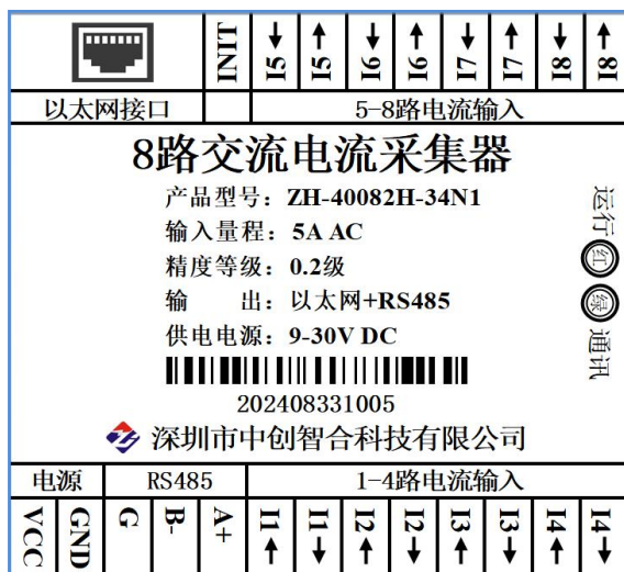
图 4.5、电流型产品引脚定义图(以太网接口)
